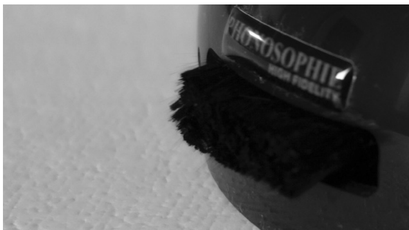
Aus der kleinen Öffnung mit der Carbonbürste treten die negativen Sauerstoff-Ionen aus.
