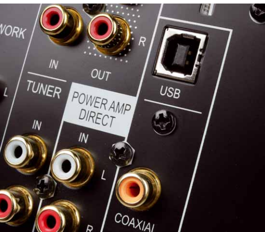
Meine Lieblingseingänge: USB geht asynchron und bis 192 kHz in 32 Bit, koaxial geht die gleiche Abtastrate
