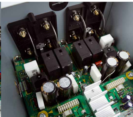
Pioneers eigene Schaltverstärker funktionieren astrein und wurden natürlich auch optimiert
