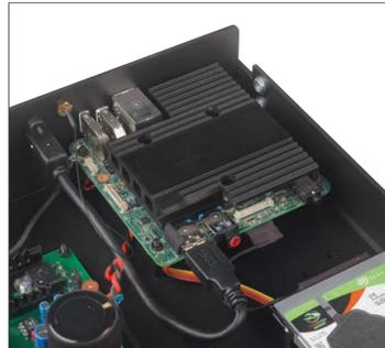
Der enorme Kühlkörper ist beinahe so groß, wie der eingesetzte Rechner und sorgt für eine gute Arbeitstemperatur
