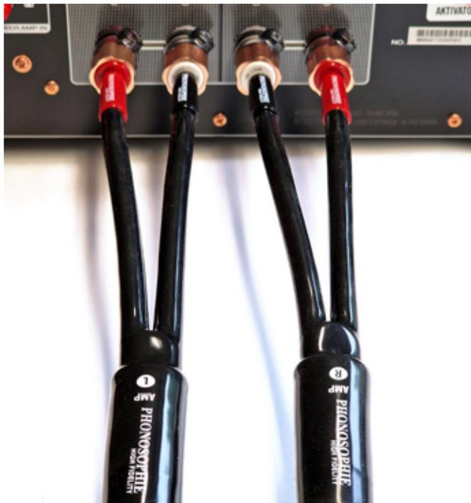
Die Konfektionierung des LS4 erfolgt von Hand, was alles andere als einfach ist. Die Stecker sind mit der Kupferlitze verlötet.
